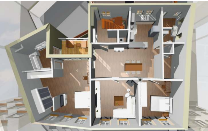
Abbildung oben (3D-Grundriss EG) Verlegung des Treppenhauses und Neustrukturierung der Gewerbeeinheit
