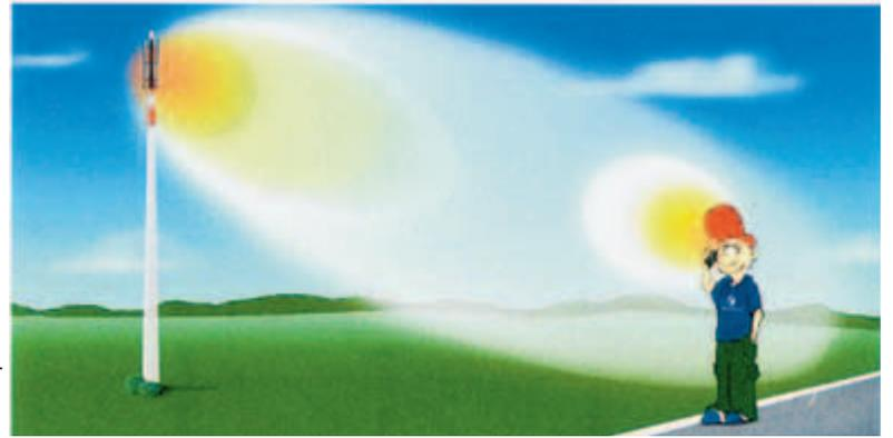
horizontal und vertikal gerichtet aus. Außerhalb der Hauptstrahlrichtung ist die Intensität der elektromagnetischen Strahlung deutlich geringer und es ergibt sich, wie bei einem Leuchtturm, eine gerichtete Strahlung mit einer „Schattzone“ (siehe Bild oben). Je weiter eine Sendeanlage entfernt ist, desto schwächer ist auch die elektromagnetische Strahlung, die Intensität nimmt mit zunehmendem Abstand zur Sendeanlage sehr stark ab.
