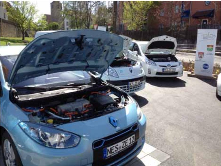
Blick in den Motorraum eines Renault Fluence - Zero Emission
