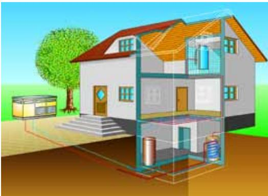
Luft ist eine wichtige Wärmequelle für den Wärmepumpeneinsatz. Die Wärme kann dabei der Außenluft oder auch aus Innenräumen entnommen werden. Sie kann somit als Wärmequelle extrem einfach und nahezu überall erschlossen werden. Es sind hierfür keine weiteren technischen Voraussetzungen wie Bohrungen oder Grabungen
