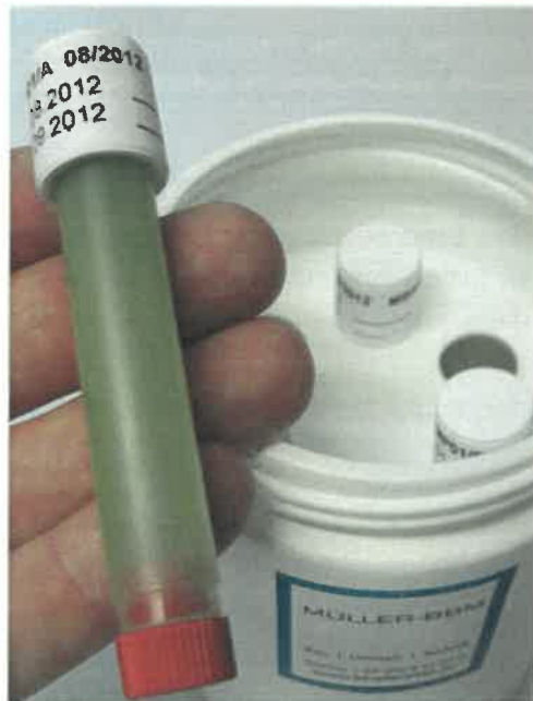
Abbildung 8: NO 2 -Passivsammler mit Witterungsschutzgehäuse (Nahaufnahme).
