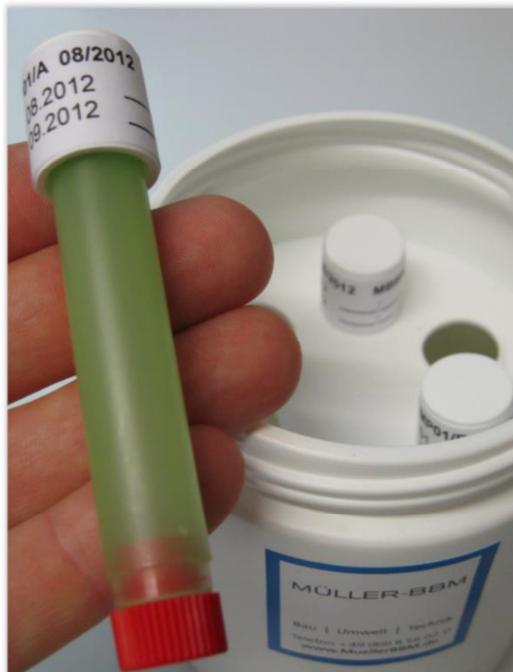
Abbildung 8. NO<sub>2</sub>-Passivsammler mit Witterungsschutzgehäuse (Nahaufnahme).
