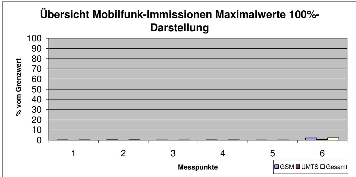
**Diagramm 4.4-5:** Maximal-Immissionen bei Vollaustattung GSM-/UMTS-Anlage (100%-Darstellung)
