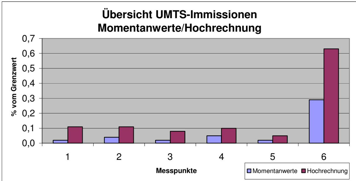
**Diagramm 4.4-2:** UMTS-Messwerte (Momentanwerte und Hochrechnung) an den Messpunkten
