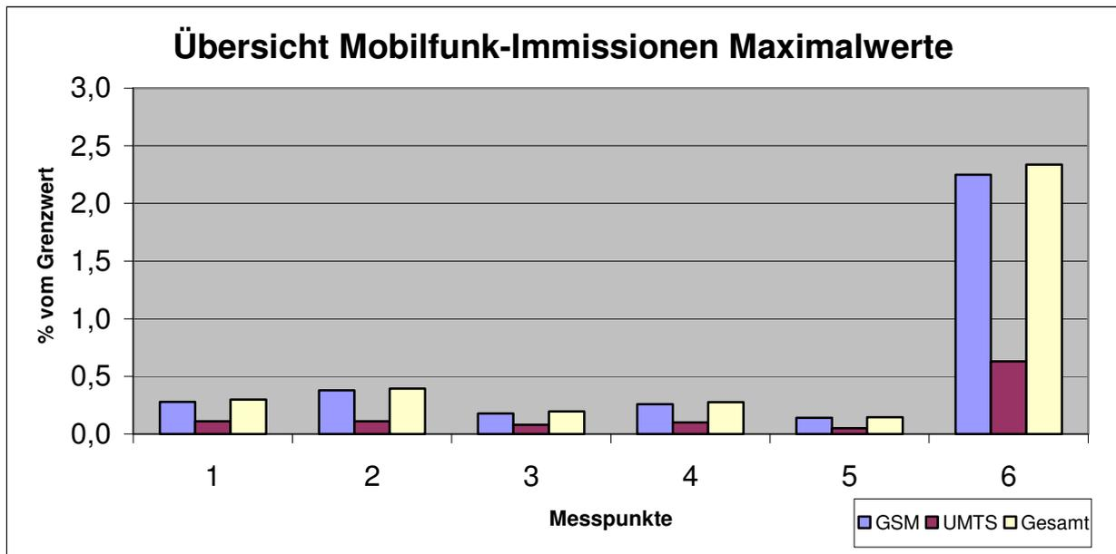
**Diagramm 4.4-4:** Hochrechnung Maximal-Immissionen GSM-/UMTS-Anlagen
