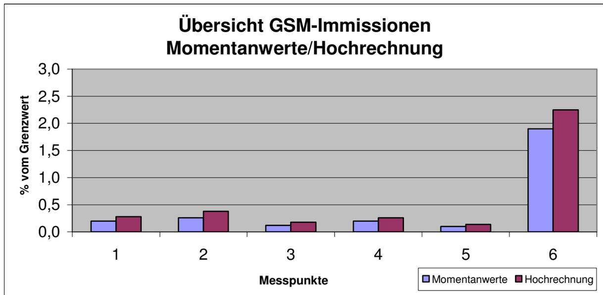
**Diagramm 4.4-1:** GSM-Messwerte (Momentanwerte und Hochrechnung) an den Messpunkten
