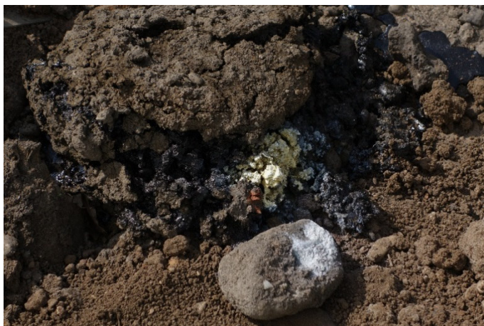
Bild 3: Positiver (gelb) und negativer (weiß) Lacktest
