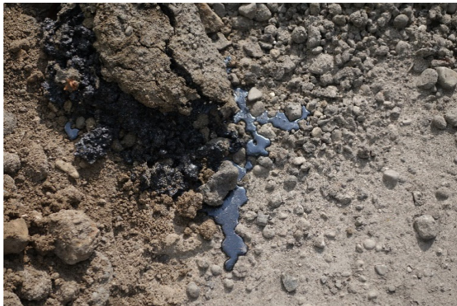
Bild 2: Von Boden umhülltes Teerölkonglomerat mit austretender Flüssigphase
