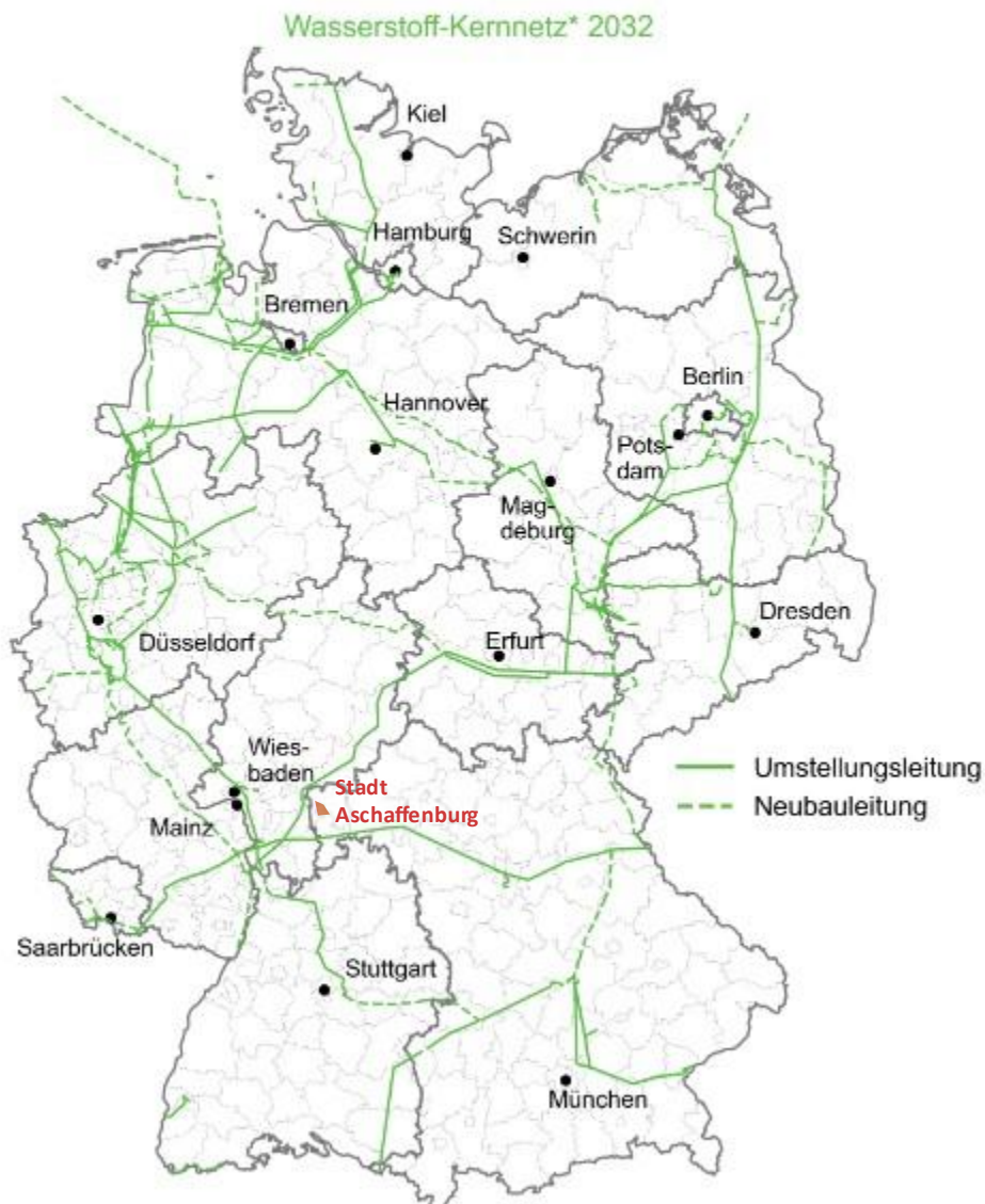
Abbildung 4: Stand Wasserstoffkernnetz gemäß Genehmigung vom 22.10.2024. Quelle: FNB [2] mit eigener Darstellung der Stadt Aschaffenburg
