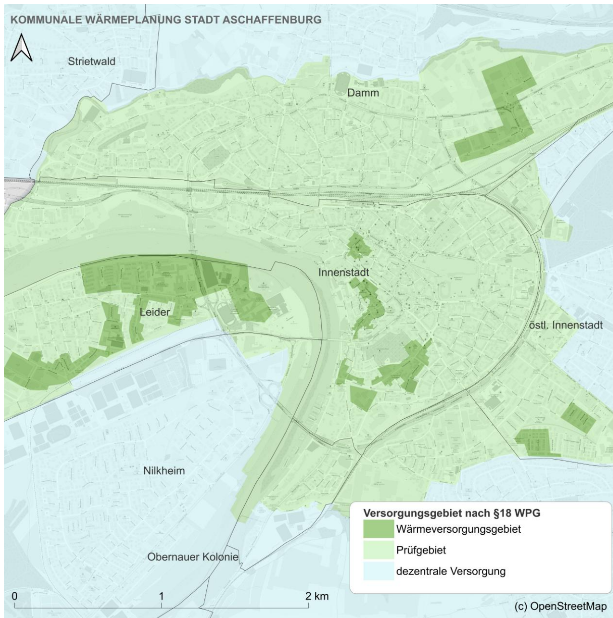
Abbildung 55: Zuschnitt der Wärmeversorgungsgebiete in der Innenstadt
